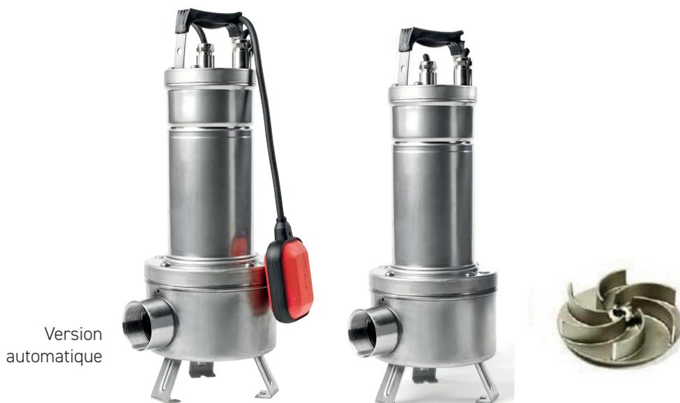
Les FEKA VS sont des pompes submersibles construites entièrement en acier inoxydable avec une roue vortex adaptée au relevage des eaux usées et chargées domestiques permettant le passage de corps solides jusqu'à 50 mm de diamètre.
